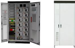
Los armarios constan de: 2 ventiladores, puerta de vidrio frontal con marco de puerta sólido, cerradura pequeña; panel de metal sólido trasero; paneles laterales extraíbles con pestillos de ABS; entrada de cable superior e inferior, 4 ruedas (dos con freno) 6 railes de 45x35x350mm (sección 2.0mm) para apoyar las baterías.
