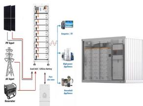
Bei Solaranlage mit Speicher und Hybrid-Wechselrichter darf man keinen Generator eingangsseitig anschliessen (wegen Rückspeisung) und es bleibt nur den Stromspeicher über ein passendes Ladegerät zu laden, falls der Energiemanagement (falls vorhanden) dies auch zulässt. Variante mit dem Inverter-Generator KS 6000iES ATS der ???
