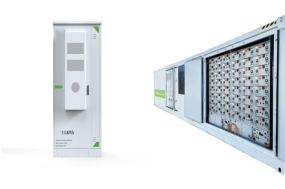
leistungsstarkes, fertig vormontiertes und skalierbares Hochvolt-Batteriesystem FoxESS EK11, max. 4 Batterien gleichen Typs parallel verschaltbar (zus?tzlich FoxESS HV-Junktion-Box ben?tigt!). Akkuzellen: Lithium-Eisenphosphat (LiFePO4), prismatisch, nutzbare Kapazit?t je Modul: 9,32 kWh, IP 65. max. Lade-/ Entladestrom: 27 A empfohlener Ladestrom: 13,5 A ???
